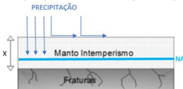
Figura 9.119 - Croqui Esquemático de um Sistema Aquífero de dupla Porosidade
