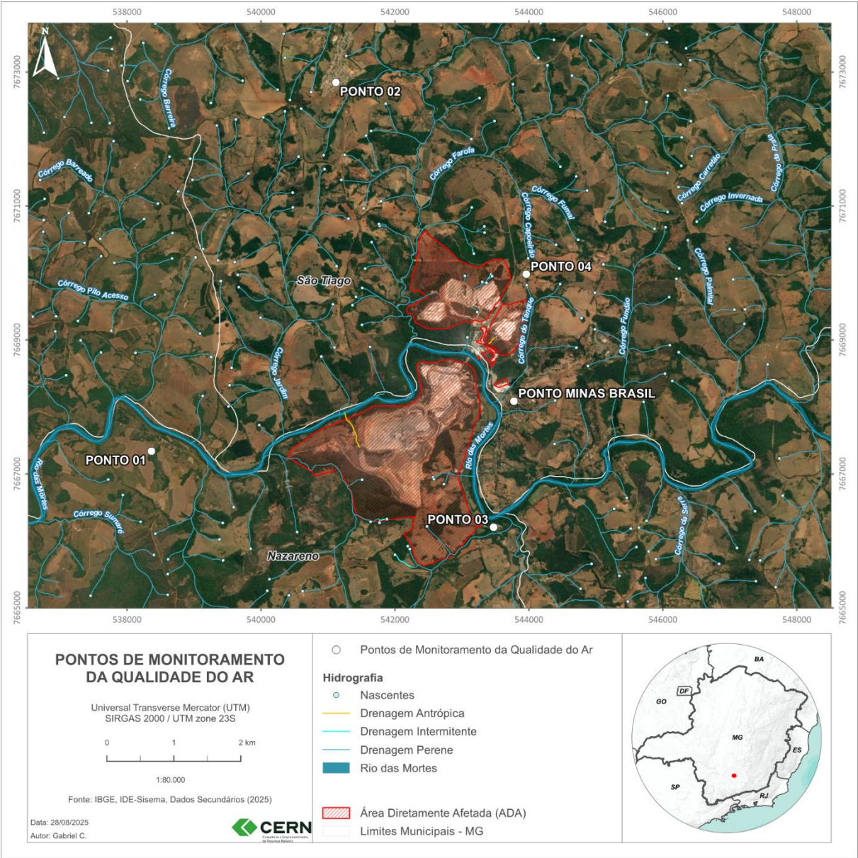
Figura 9.27 - Pontos de Monitoramento de Qualidade do Ar em relação à ADA do Projeto Ampliação Mina Volta Grande
