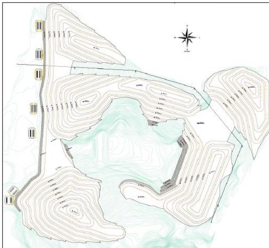
Devido à geometria da pilha temporária, ela pode ser subdividida em três setores: sul, central e norte. No entanto, trata-se de um único maciço contínuo, sem divisão estrutural entre os setores. A área total de deposição é de 880.440 m<sup>2</sup>, com volume estimado de 15.766.799 m<sup>3</sup> e cota máxima na El. 992 m, sendo a distribuição volumétrica por setor da seguinte forma:
