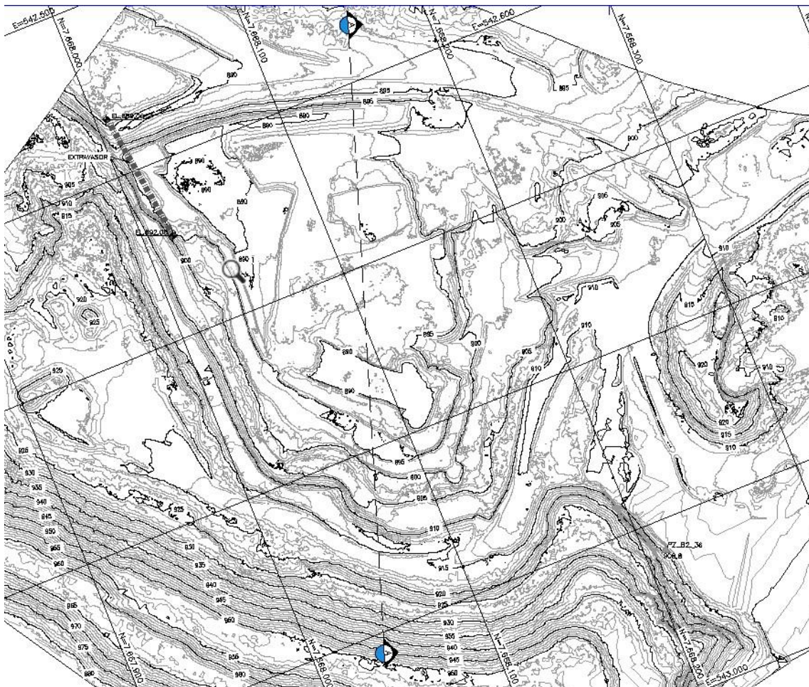
Figura 7.1. - Barragem VG2: Planta topográfica da Barragem Volta Grande 02 (Levantamento topográfico realizado em 08/2023 [Ref. 1]) e localização da Seção A-A'.
