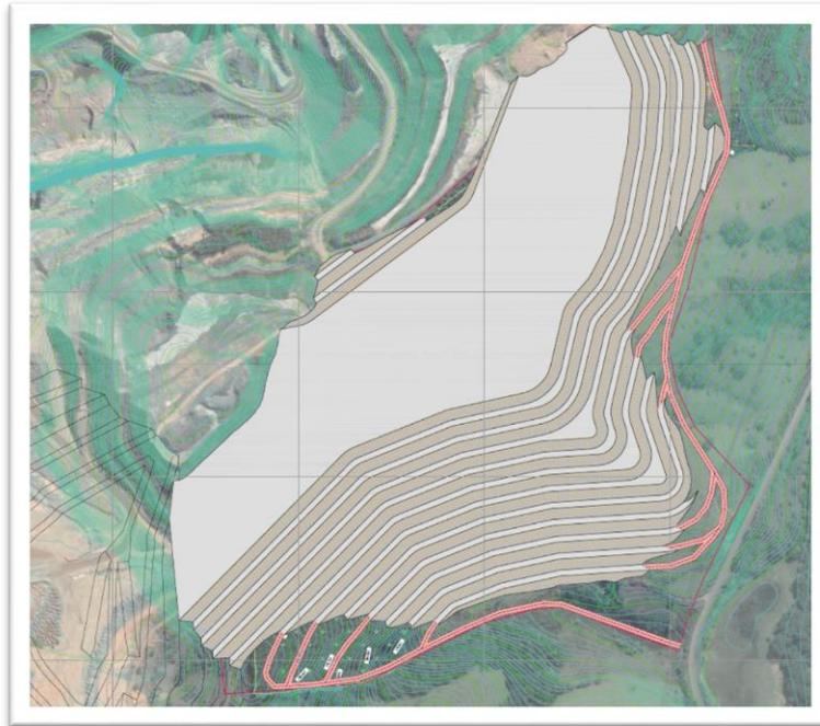
O volume máximo de deposição para essa pilha é 9,6 Mm<sup>3</sup> e a área utilizada para sua construção é 36,95 ha, excluindo a área de implantação do *sump* para contenção de carreamento de material que é 0,75 ha.
